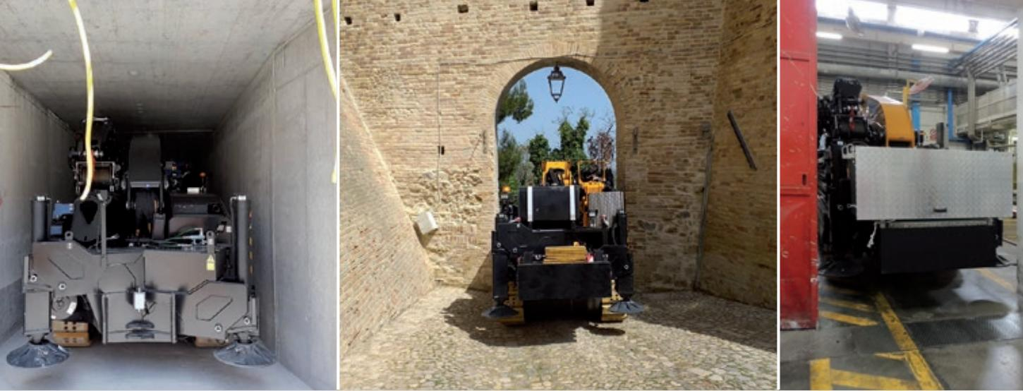
Meno centimetri in altezza, lunghezza e larghezza ed un controllo millimetrico di avanzamento, consentono il raggiungimento di luoghi precedentemente preclusi a gru con tali prestazioni. Dimensioni record 4608X1650, H 2443 mm.
