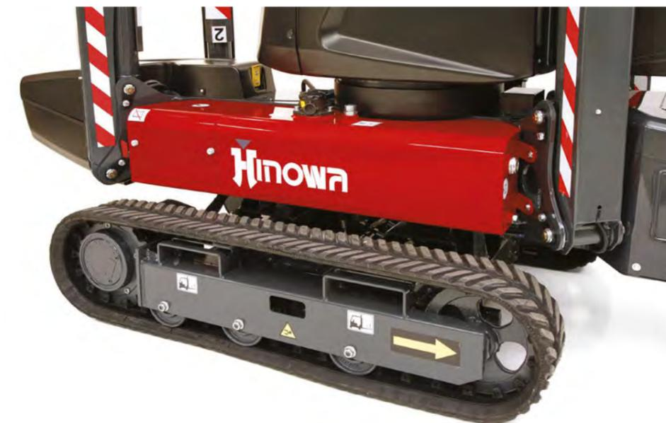
▼ **Le train de roulement est construit en utilisant des moteurs de traction électriques** (à l'exception du TC22 diesel et bi-énergie) qui lui permettent de se déplacer sans l'utilisation d'huile hydraulique. La technologie des moteurs à aimants permanents garantit un rendement plus élevé que les moteurs électriques traditionnels.
