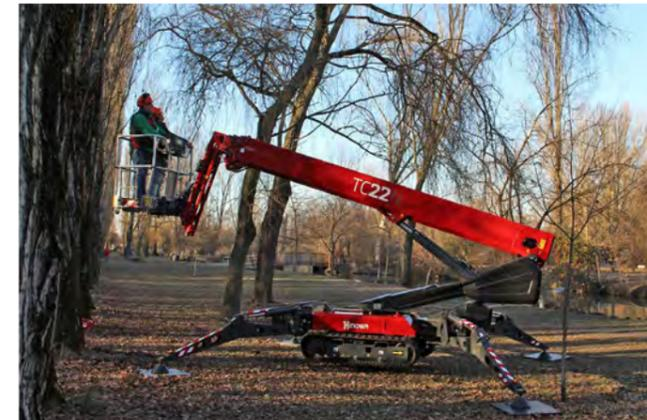
▼ **Fonction « Go Back »** : la machine, avant de lancer la fonction « Go Home », mémorise la dernière position de travail dans laquelle elle se trouve de sorte à y revenir automatiquement en appuyant sur un seul bouton. C'est une fonction unique qui permet un gain de temps important et une augmentation significative de la productivité.
