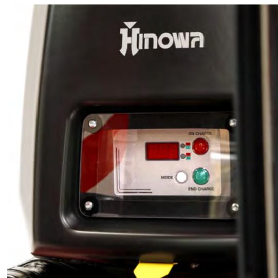
Chargeur de batterie et affichage indiquant l'état de charge.
