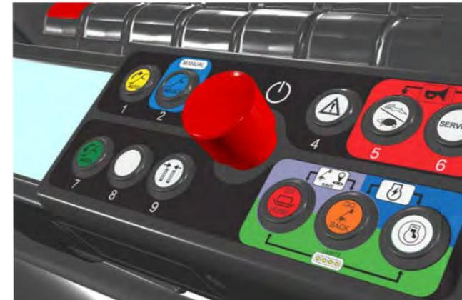
▼ **Fonction « Go Home »** : elle permet de fermer et d'aligner le bras télescopique, automatiquement et en toute sécurité, pour amener la machine en position de transport en appuyant sur un seul bouton.
