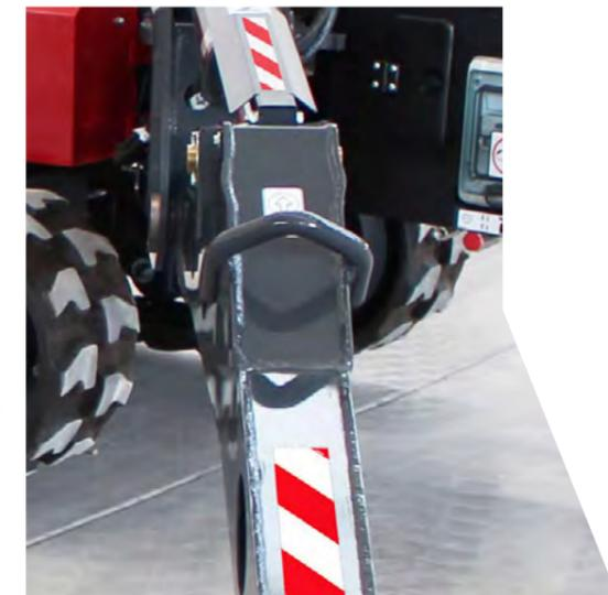
**Crochets de levage** sur les stabilisateurs Heavy Duty pour la mise en place sur chantier avec une grue de levage.
