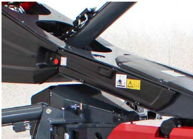
Position pour commandes d'urgence de la partie aérienne et avec clé de fermeture pour garantir la maximale sécurité.
