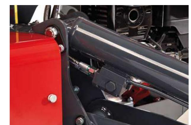
**Doubles clapets de sécurité** sur stabilisateurs avec protection de l'ensemble.
