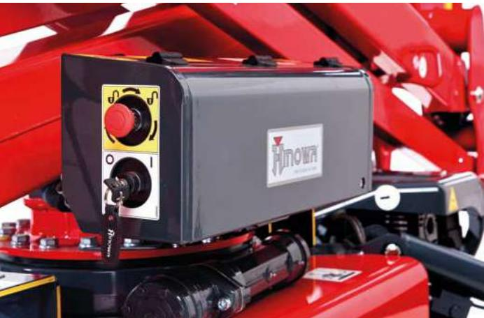
**Position pour commandes d'urgence de la partie aérienne et avec clé de fermeture pour garantir la maximale sécurité.**
