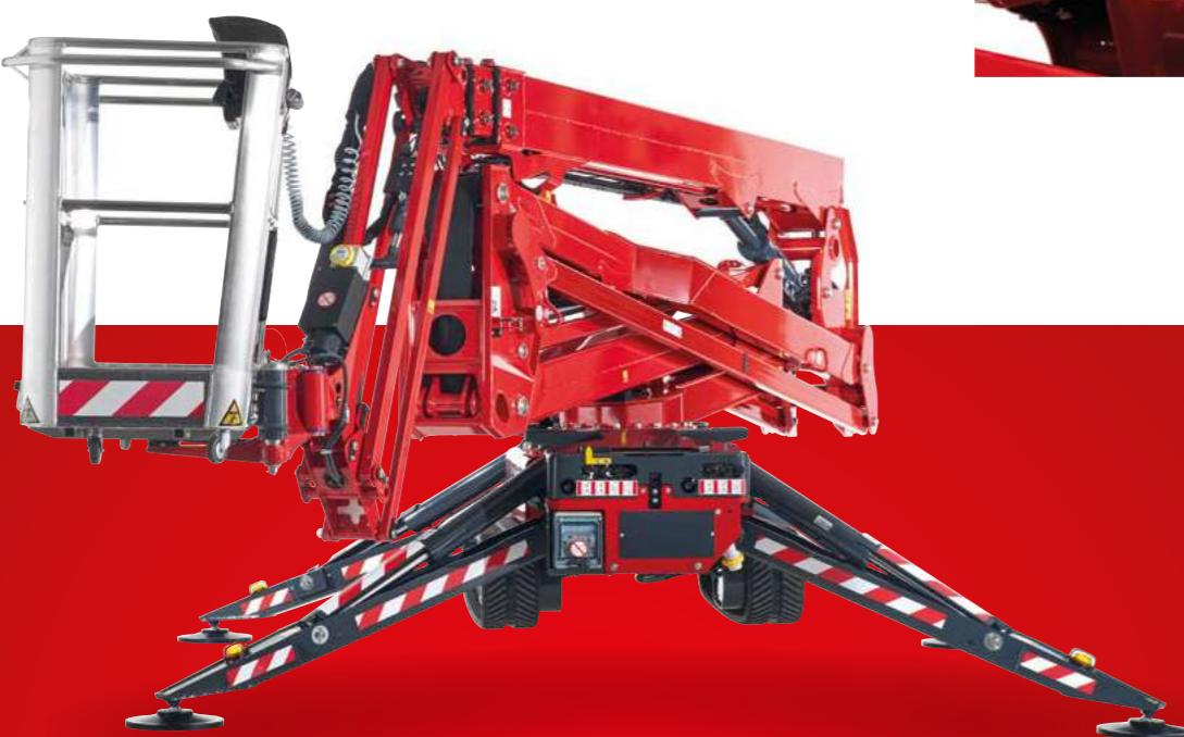
**Rotation du panier** 124° (+/- 62°), stabilisation et fermeture des stabilisateurs automatique IIIS.
