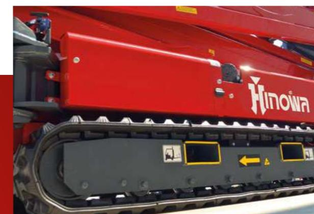
**Logement pour fourches chariot élévateur ou telehandler** pour le levage, chargement, déchargement et transport de la machine.
