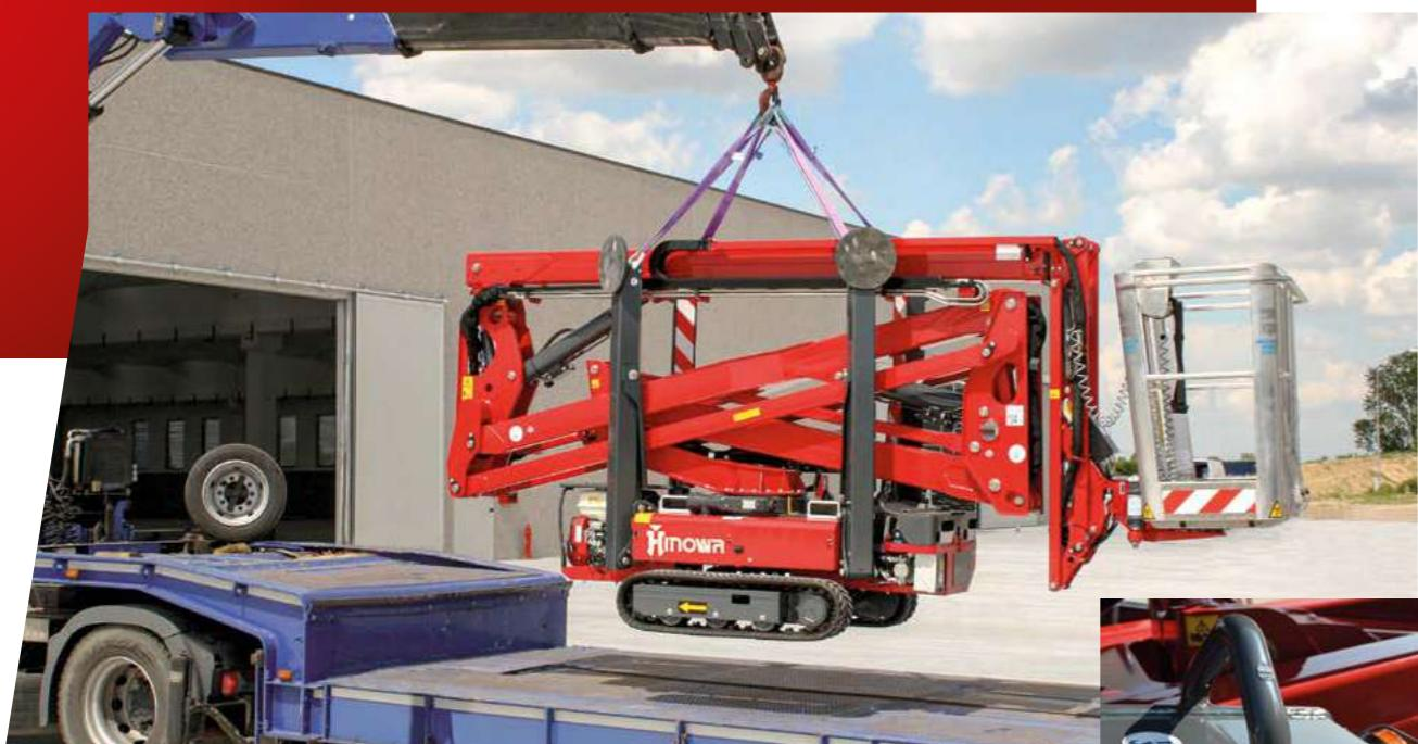
**Crochets de levage** sur les stabilisateurs
