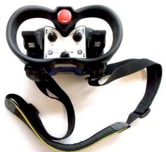
**Radiocommande supplémentaire.** Elle garantit le plus grand confort durant le chargement/déchargement, la translation et les procédures automatiques de stabilisation et déstabilisation. Elle est compacte, fonctionnelle, extrêmement maniable et est positionnable à l'intérieur du boîtier de commande au sol.
