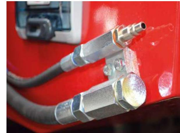
**Ligne auxiliaire Ø1/4" dans le panier standart pour permettre l'utilisation de différents outils, par exemple, à air.**
