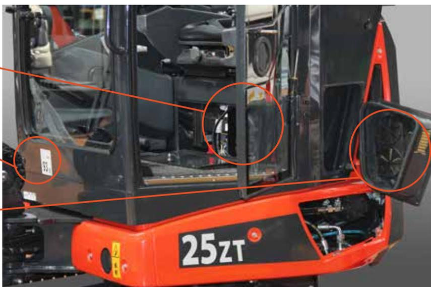
Le logement des filtres de ventilation cabine permet un contrôle immédiat et l'éventuel remplacement des mêmes.
