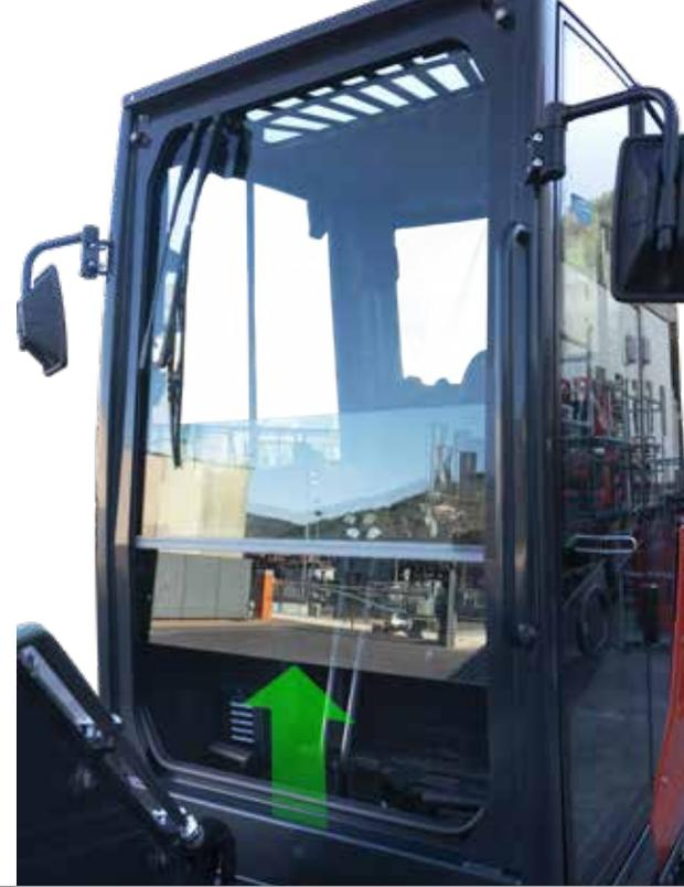
La vitre latérale coulissante et le pare-brise avant à ouverture assistée (avec des vérins à gaz) offrent une visibilité maximale à l'opérateur.
