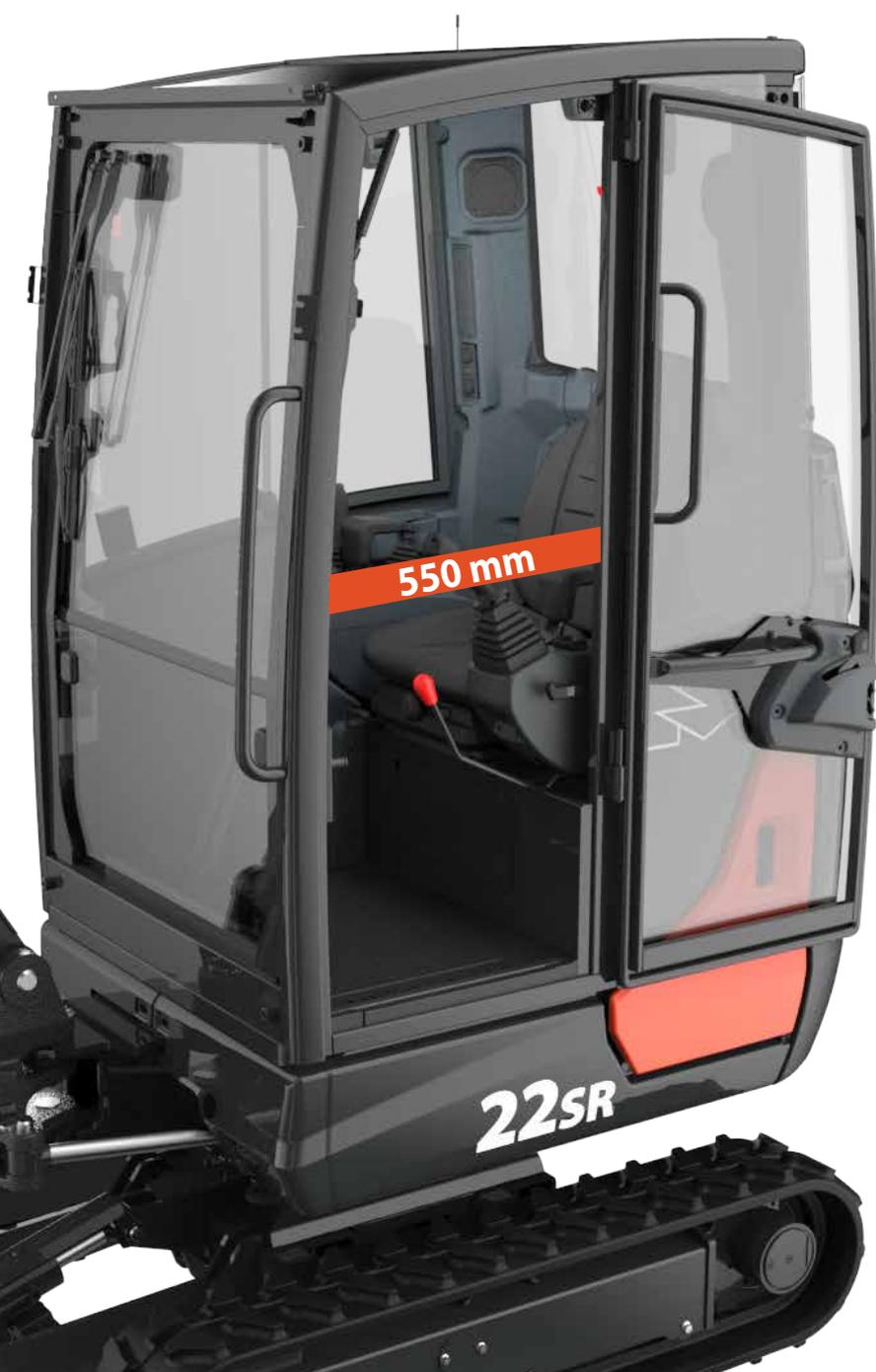
Grâce à l'entrée plus large (550 mm), l'opérateur peut monter et descendre confortablement de la cabine, avec la garantie d'une accessibilité égal à celle de machines de catégorie supérieure.
