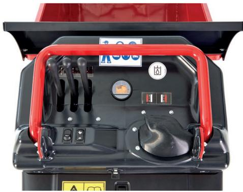
Panneau de commande encore plus simple et plus sûr à utiliser grâce aux joysticks ergonomiques et au bouton "enable" utile pour empêcher l'opérateur de se déplacer accidentellement et la possibilité de choisir entre deux vitesses: "ecomode" sur les surfaces inégales et pour économiser l'énergie "power" sur terrain plat.
